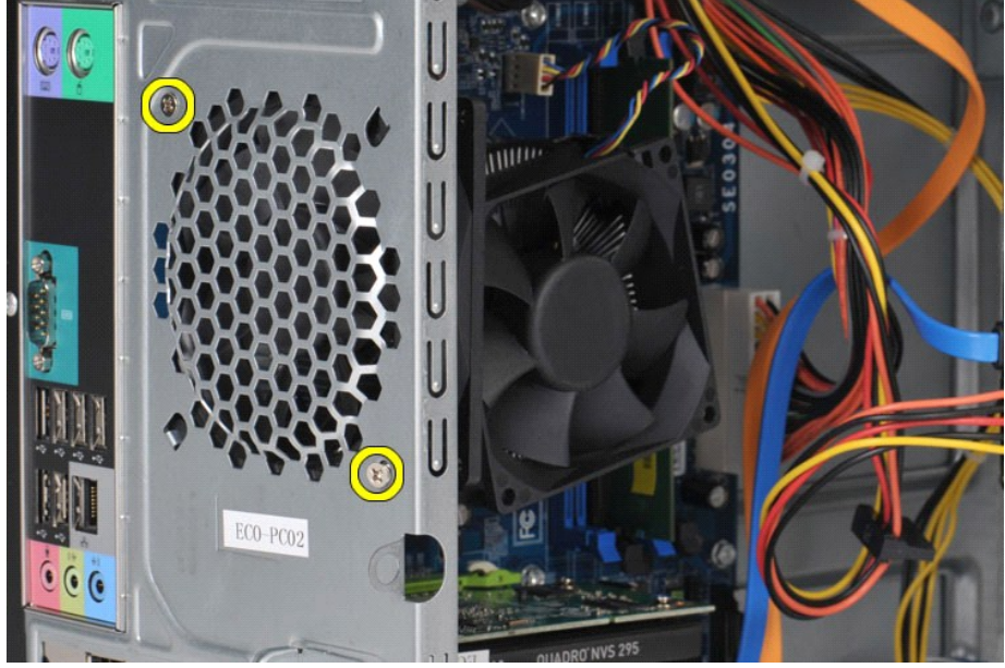
5. حرك المروحة ببطء وعلية نحو منتصف الكمبيوتر، وارفع المروحة بعيدا عن الهيكل.
