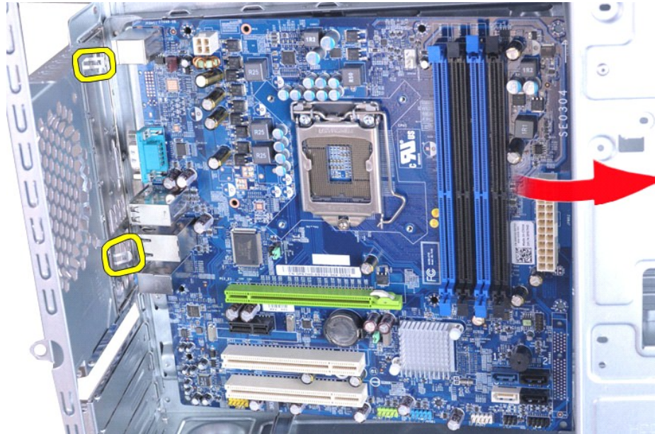
⚠ تحذير: عند إعادة تركيب لوحة النظام، حرك لوحة النظام تحت الأسننة المعدنية. بمعنى أن يؤدي الضغط على لوحة النظام إلى أسفل (عند وضعها على الأسننة المعدنية) إلى تضرر لوحة النظام. 11. ضع لوحة النظام في غلاف واق ضد الشحنات الاستاتيكية.
